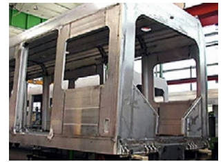
EB-geschweißter Obergurt nach der Weiterverarbeitung im Waggonbau
