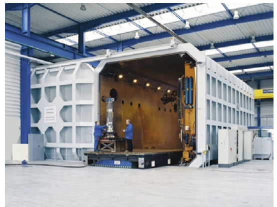
Elektronenstrahl-Schweißkammer mit 600 m 3 Kammervolumen
