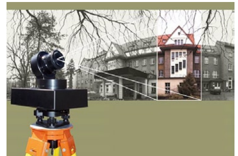
Rotationscanner/CCD-Zeilenkamera zur digitalen Gebäudevermessung Aufnahme in Kegelprojektion
