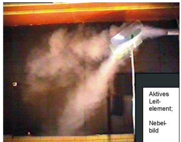
Versuchseinrichtung mit aktivem Leitelement und Darstellung des Strömungsverhaltens
