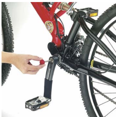
Mit einer Schlüsselbewegung wird das Tretlager gegen Pedalbewegung gesperrt.
