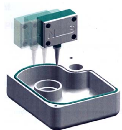
Aufbringen der Dichtung
