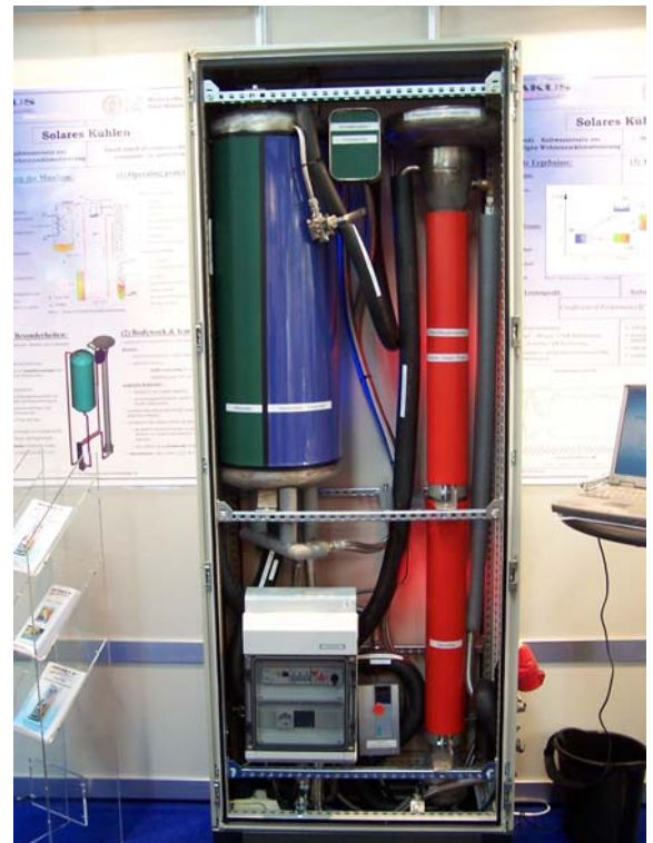
Prototyp der Absorptionskälteanlage
