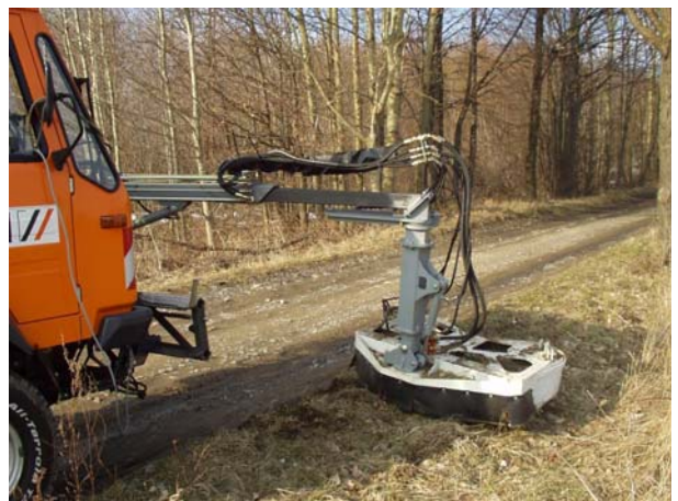
Multicar mit Versuchsmuster eines Hindernismähers
