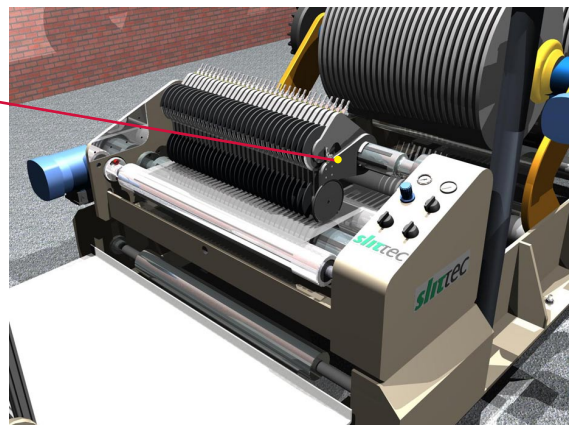
Entwickeltes Schneidsystem mit schmalen Messerhaltern
