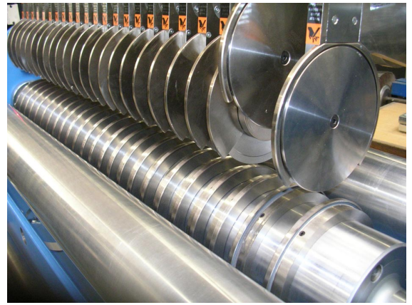
Anordnung von Ober- und Untermessern beim Schneiden
