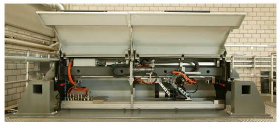
Gesamtansicht der geöffneten Box mit Spiegel- und Linsenschlitten auf der Translationsachse
