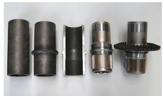
HOTFORMTEC: Rohre aufweiten und/oder partiell verdicken
