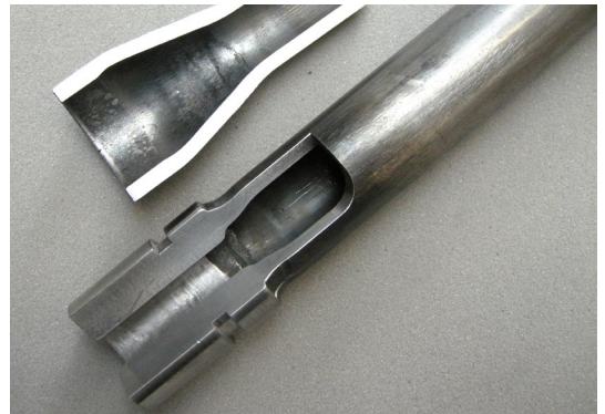
HOTFORMTEC: Rohre aufweiten und/oder partiell verdicken
