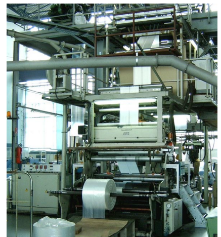
Blasfolienanlage mit Ultraschallmessung
